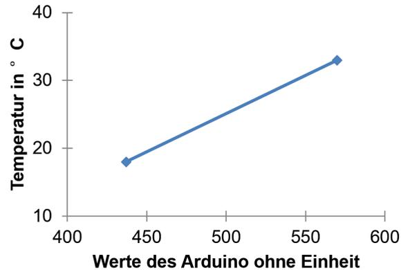
Im Diagramm oben ist der Wert 437 einer Temperatur von 18°C zugeordnet und analog der Wert 570 zu 33°C.
